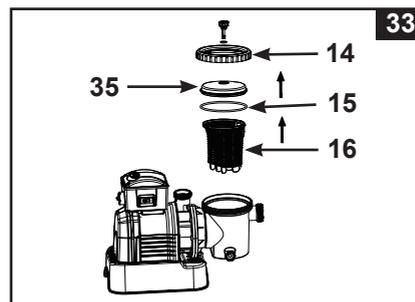
5. Опорожните и промойте корзину садовым шлангом, можете использовать пластмассовую щетку для удаления отложений из корзины. Не используйте металлическую щетку.
