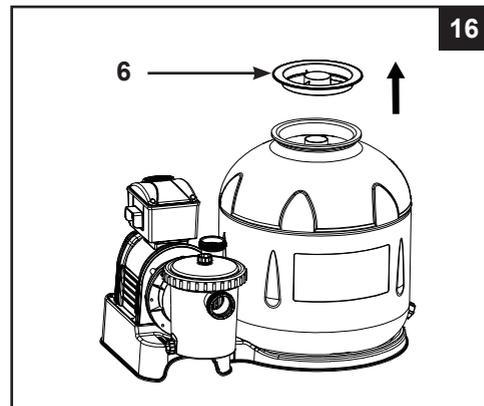
3. Аккуратно распределить песок внутри резервуара, налить небольшое количество воды для предотвращения образования воздушной подушки при дальнейшем наполнении песком. Это поможет так же избежать смещения центральной трубки (7) от избыточного давления (см. рис. 17). Положить песочный щит (6) снова и продолжить насыпание песка.
