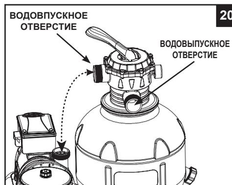
2. Разместите L-образное уплотнительное кольцо (11) на впускном патрубке 6-ходового клапана и на выпускном отверстии двигателя насоса. Движением по часовой стрелке соедините соединительный шланг песочного фильтра (13) между выпускным отверстием двигателя насоса и впускным патрубком 6-ходового клапана (см. рис. 21).
